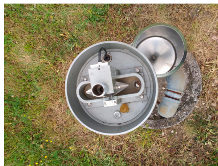
Slika 8. Padavinska stanica MS Bihać ('tipping bucket' ili vaga – mjerenje padavina)
