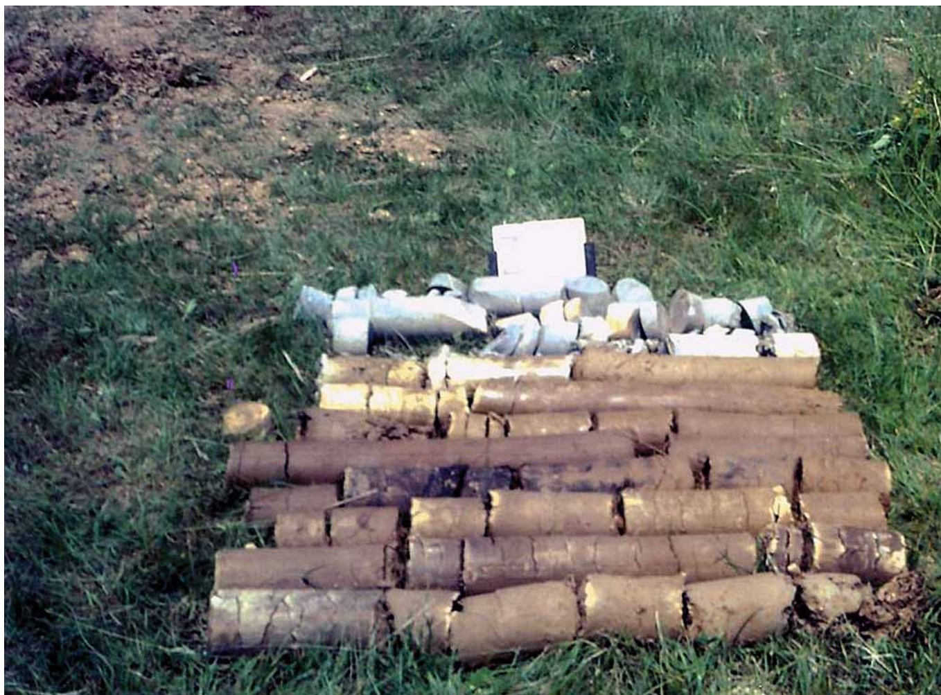
Slika 5: Zenica – Sondažom kod geoloških istraživanja može se ustanoviti redosljed različitih slojeva, što je važno kod izvodjenja rekultivacije
