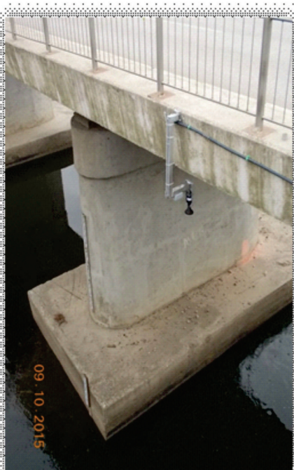
Slika 3.: Radarski uređaj za mjerenje vodostaja smješten na mostu
