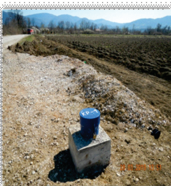
Slika 9. i 10.: Pijezometri za mjerenje nivoa podzemne vode
