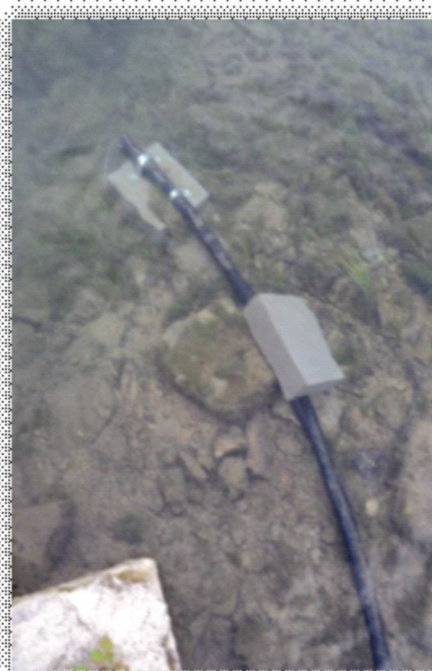
Slika 4.: Mjerni senzori/sonda za mjerenje vodostaja smješteni direktno u vodotoku
