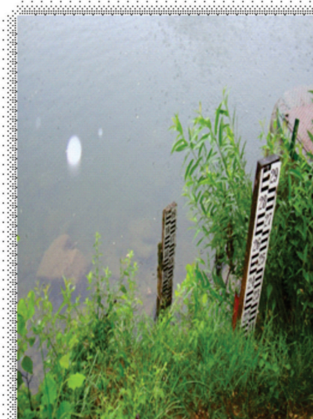
Slika 4.: Mjerni senzori/sonda za mjerenje vodostaja smješteni direktno u vodotoku
