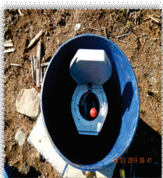
Slika 9. i 10.: Pijezometri za mjerenje nivoa podzemne vode
